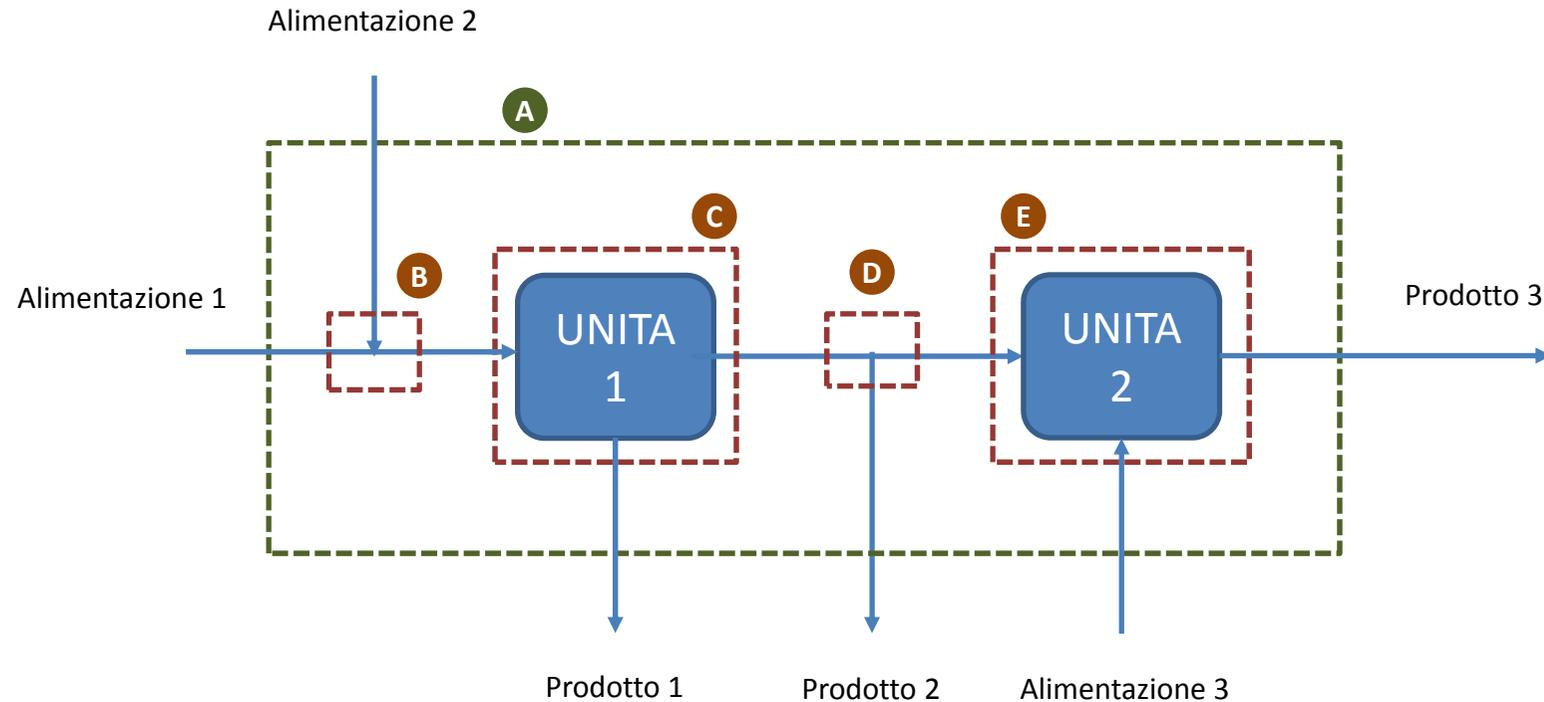
Il confine A racchiude tutto il processo, il sistema definito da questo confine ha come input le alimentazioni 1,2,e 3 e come uscite i prodotti 1, 2 e 3. Il bilancio di questo sistema si definisce bilancio complessivo. Il flusso che unisce l'Unità 1 con l'Unità 2 è interno al sistema e non deve essere considerato nel bilancio complessivo.
